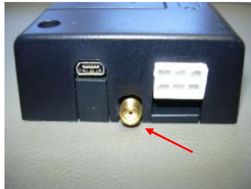
Anschluss der GPS-Antenne
